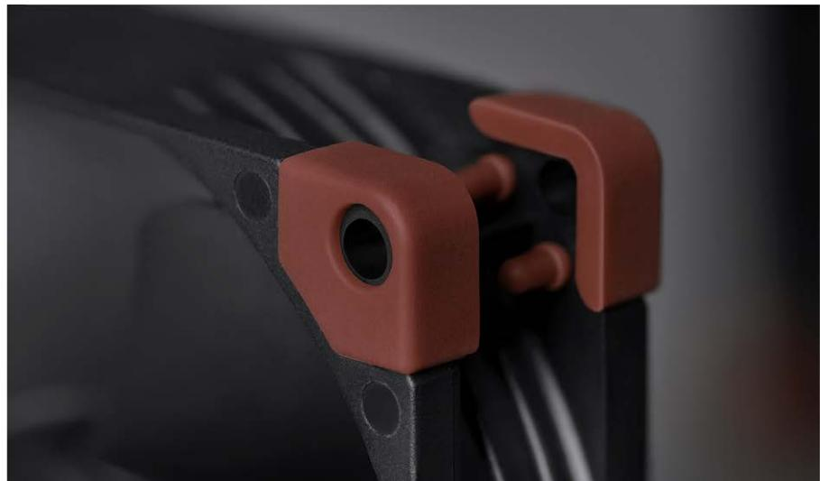
Das NA-SAVP5 Set ist ein Zubehörpaket für Lüfter, das aus 16 braunen NA-AVP5 Anti-Vibrations-Pads für bis zu 2 kompatible 92/80mm Lüfter besteht. Die aus extra-weichem Silikon gefertigten Anti-Vibrations-Pads verringern die Übertragung minimalster Vibratoren und sind zugleich mit allen Standard-Schrauben und den meisten anderen Montagesystemen kompatibel. Zugleich setzt die braune Originalversion bei der Verwendung mit Noctuas chromax Lüftern subtile braune Farbakzente.
