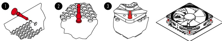
Si besoin, il est aisé de détacher les silentblocs intégrés aux angles du NF-A8 FLX:
