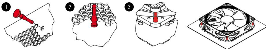
Si resultara necesario, puede quitar los paneles anti-vibración integrados del NF-A8 ULN fácilmente:
