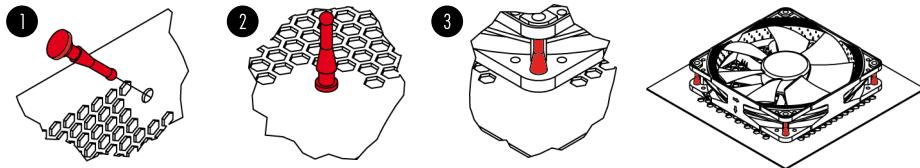
Si besoin, il est aisé de détacher les silentblocs intégrés aux angles du NF-S12A FLX:
