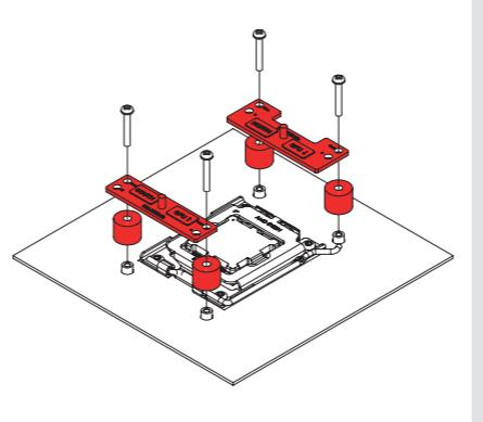
Wählen Sie für AM5 und AM4 CPUs der Serien Ryzen 5000/3000 die versetzte Lochposition von -7mm, um eine optimale Kontaktqualität und Leistung zu gewährleisten.
