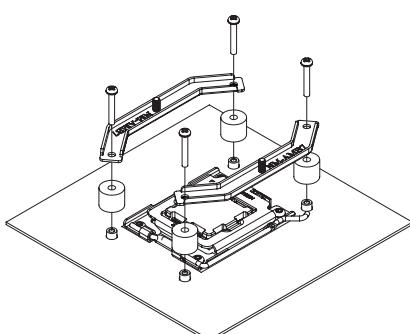
*Bitte beachten Sie, dass das NM-AM5/4-MP78 Set ausschließlich mit Kühlern kompatibel ist, die über einen Montageabstand von 78mm verfügen, und dass für Kühler mit 83mm Montageabstand das NM-AM5/4-MP83 Set verwendet werden muss.*
