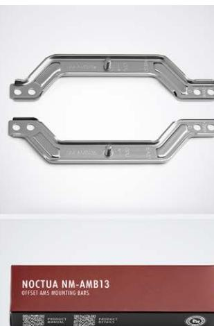
NM-AMB13 是用于安装间距为 83mm，需要在插槽的东西侧安装点以获得更好的方向的 NOCTUA CPU 散热器偏置 AM5 安装杆，例如流行的 NH-U12P (SE2)、NH-U12(F)、NH-U9B (SE2) 或 NH-U9(F)（参见详细的兼容性列表）。通过将散热器向插槽的南侧偏移 7mm，可以在 CPU 的 CCD 正上方施加更多的压力。这种在处理器热点处的改进接触可以显著地降低 CPU 温度，一般改善的温度范围为 1-3°C。NM-AMB13 更换了标准安装条，请重新使用原来的垫片和螺丝，这是一种简单而高效的措施，用于优化基于 AM5 的 AMD Ryzen CPU 的散热性能。
