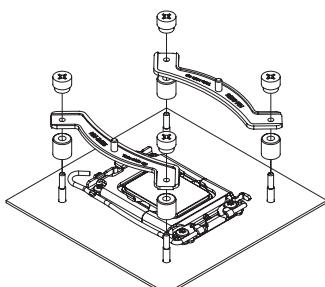
注意：这款安装升级套件可以在 LGA1700 (LGA17xx 系列) 平台上安装 Noctua 散热器，该散热器起初的设计规格是用于其他插槽。由于 LGA17xx 的间隙规格与其他插槽不同，因此在安装前确认您的散热器与 LGA17xx 主板完全兼容是非常重要的。
